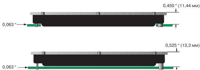
Рис. 3. Монтаж модулей «в плату» и «на плату»
